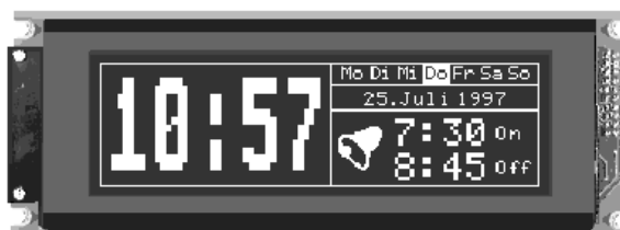
Bild 1.26: LCD-Grafikdisplay EA GE240-6KCV24
