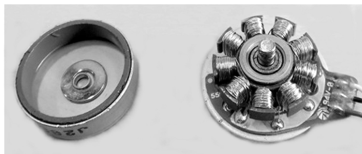
Bild 2.6: Geöffneter BLDC-Motor mit glockenförmigem Rotor
