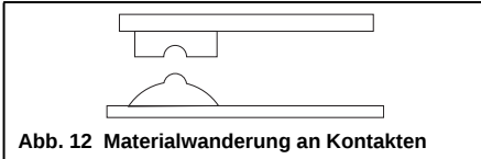
Abb. 12 Materialwanderung an Kontakten
