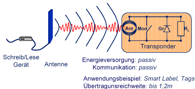
Abbildung 2.4: Funktionsweise eines passiven RFID-Systems [Inf 03]
