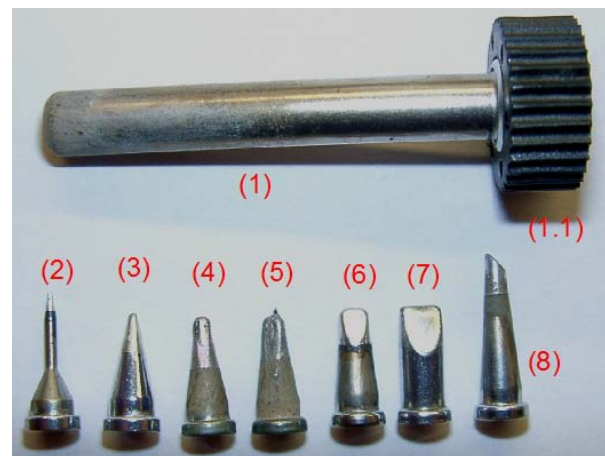
Abbildung 4: Lötspitzen und Hülse
